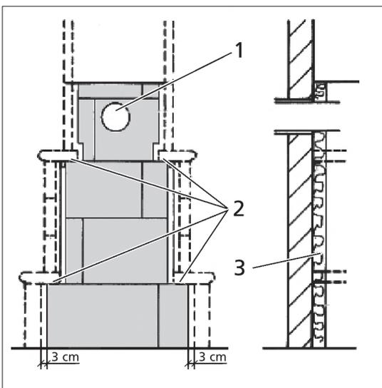
Bild 2-7 Dämmung des Ofenmauerwerkes
