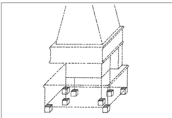
Bild 2-4 Punktfundamente (bauformabhängig)
